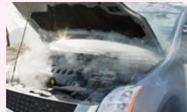
冷却不良によるオーバーヒート
